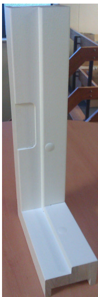
Houten kozijn (schaalmodel) voorzien van afdekdopjes
